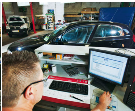
Ins Motorsteuergerät geschaut: Am Diagnosegerät lassen sich Ölflaschenvolumen, Rußwerte und die seit der letzten Regeneration zurückgelegte Strecke auslesen
