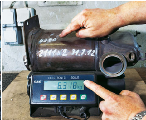
Dokumentiert: Jeder Rußpartikelfilter wird vor und nach der Reinigung gewogen. Dieser Filter wurde immerhin um 62 Gramm Ruß und Asche erleichtert
